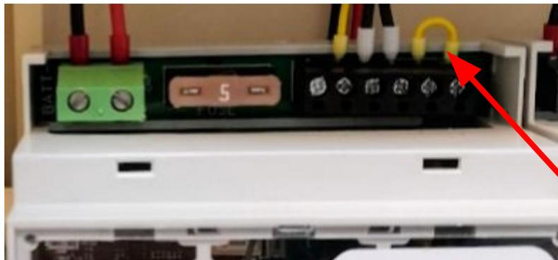
Un strap est présent à droite dans le bornier supérieur de la régulation.
